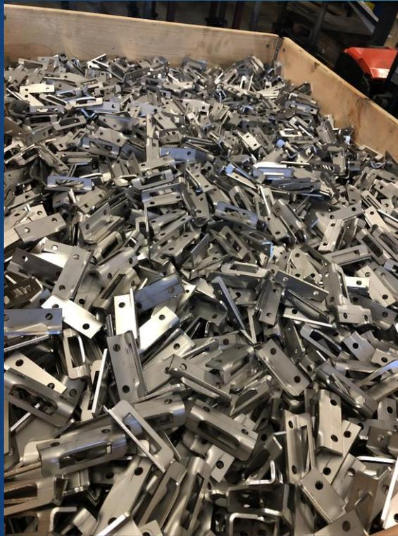
Laserteile S355 in 30 mm
